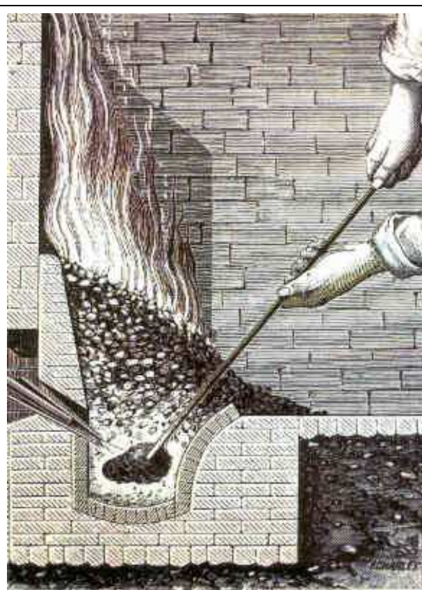
Esquema de una farga catalana [ www.10gencat.net/agaur.web/recursos/La_Farga/Docs/0-introduccio,htm ]
